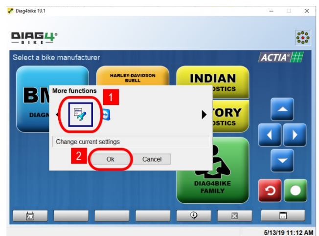
Fig. 37 – Hacer clic sobre el icono de configuración (nota 1) y confirmar (nota 2) para iniciar la configuración misma de la medición analógica(foto ilustrativa)
