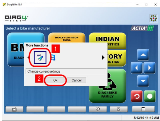
Abb. 37 – Durch das Anklicken der Konfigurations-Schaltfläche (pos 1) und die Bestätigung (pos 2) wird die eigentliche Konfiguration der Analogmessung gestartet (illustrative Bild)
