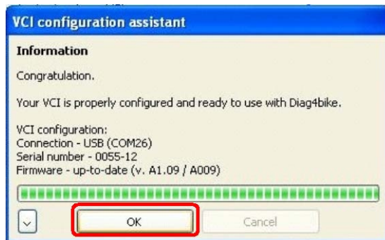
Abb. 24 – Informationsfenster mit positiv durchgeführter Firmwareaktualisierung
