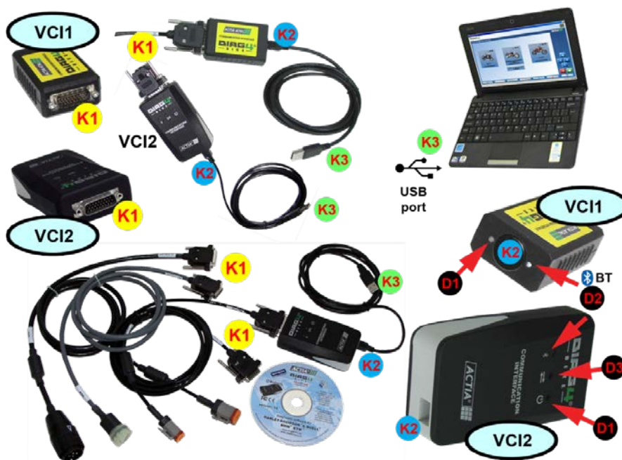
Fig. 20 – Description et connexion de l'interface de communication VCI (1 - AT531 5075, 2 - AT532 5007)
