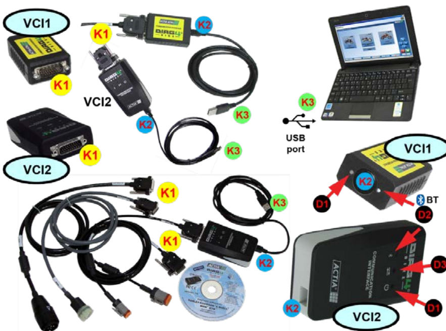
Fig. 20 – Descrizione e collegamento dell'interfaccia di comunicazione VCI (1 - AT531 5075, 2 - AT532 5007)
