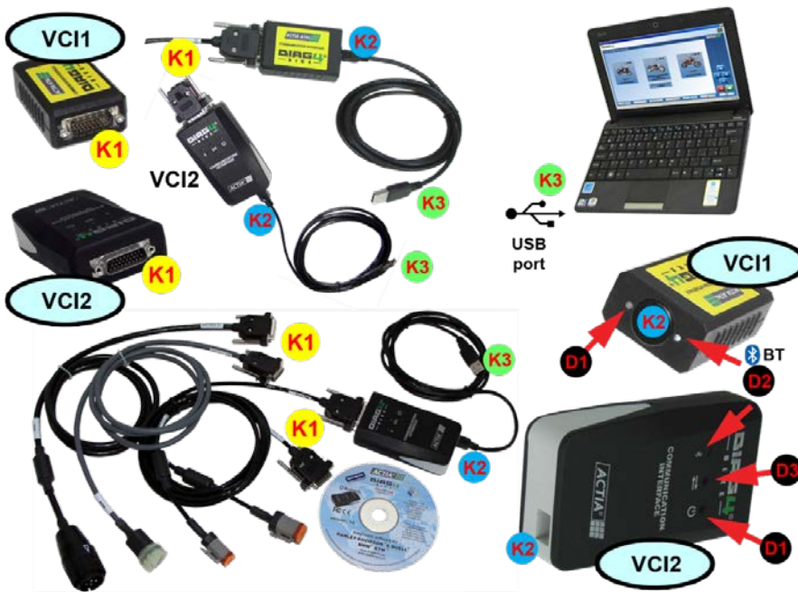
20. ábra – a VCI kommunikációs interfész leírása és csatlakoztatása (1 - AT531 5075, 2 - AT532 5007)
