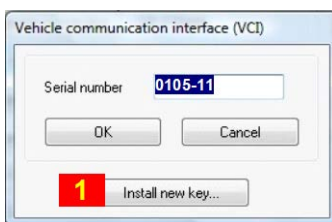
Abb. 12 – Schaltfläche zur Eingabe des „Dauerschlüssels“
