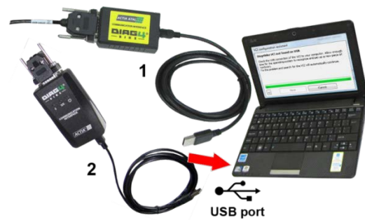
Abb. 16 – Informationsfenster mit der Aufforderung zum Anschließen der VCI-Schnittstelle an den Rechner (1 - AT531 5074, 2 - AT532 5006)
