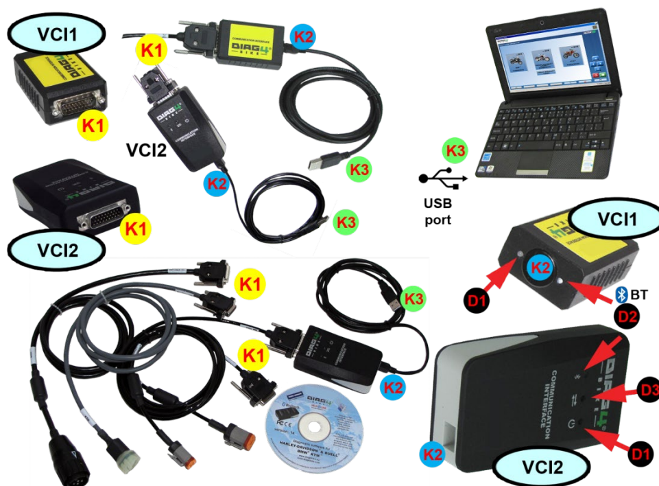
Obr. 20 – Popis a zapojení komunikačního rozhraní VCI (1 - AT531 5075, 2 - AT532 5007)
