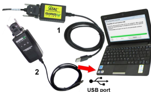
Obr. 16 – Informační okno s požadavkem na připojení VCI k počítači (1 - AT531 5074, 2 - AT532 5006)
